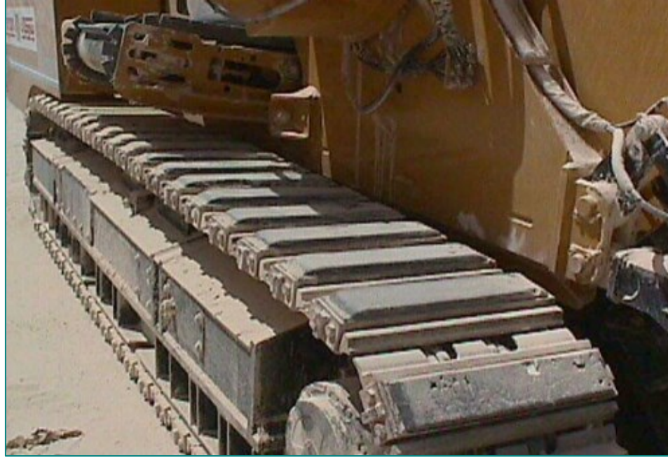
الشكل (13): التغطية المطاطية للجنزير لحماية سطح الأسفلت
